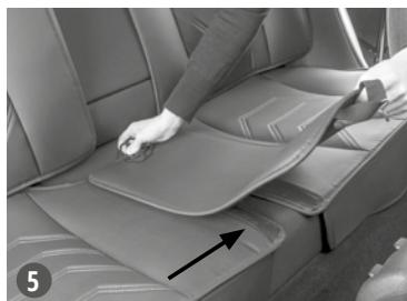
**DE** 5. Legen Sie das Mittelstück auf die Klettverschlüsse, um den Spalt zwischen den Flächen abzudecken.
